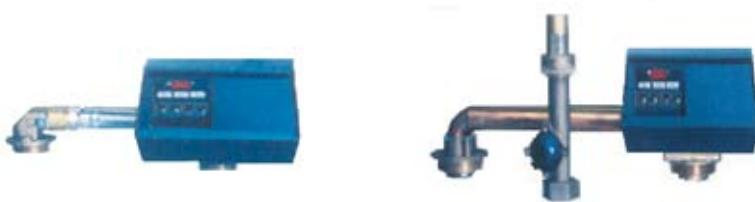
**OMEKŠIVAČ VODE** - VAD je koncipiran po duplex sistemu koji Vam omogućava kontinuiran proces proizvodnje omekšane vode tako što tankovi rade i regenerišu se naizmenično. Trenutak kada započinje regeneracija podešava se na upravljačkom ventilu FLECK koji reguliše proces. Upravljački ventil se programira u zavisnosti od karakteristika vode i njenog protoka. Vreme za regeneraciju je takođe unapred programirano na upravljačkom ventilu u zavisnosti od potreba korisnika.
