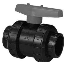
Kugelhahn S5 2W PVC grau PE-Schweißstutzen metrisch PN10 EPDM PTFE einzeln verpackt Ball Valve S5 2W PVC grey PE fusion spigot metric PN10 EPDM PTFE single packed
